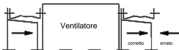
Prestare attenzione alla corretta direzione della corrente d'aria! L'aria deve muoversi all'interno del cono altrimenti si originano ulteriori perdite di corrente.
